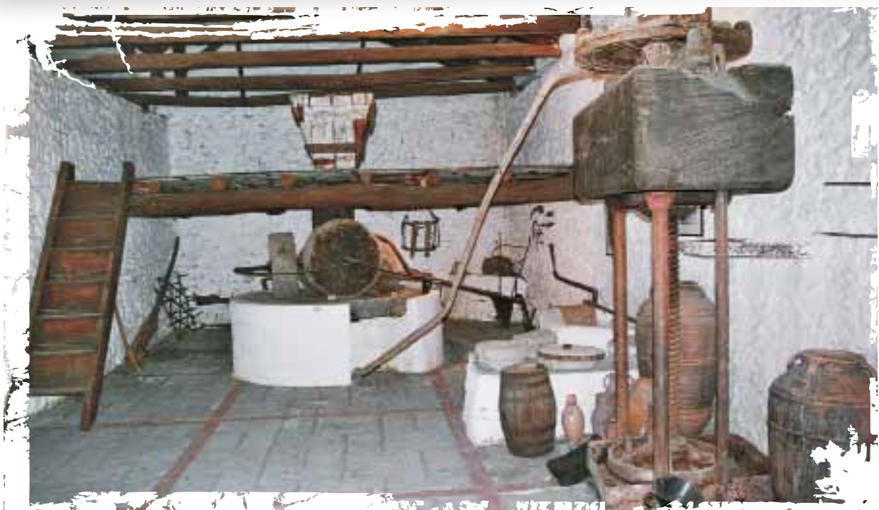
Διμυλιά. Ζωοκίνητο ελαιοτριβείο. Ελαιόμυλος με τέσσερις μυλόπετρες, φωτ. Μ. Ανδρουλάκη, 2007.
