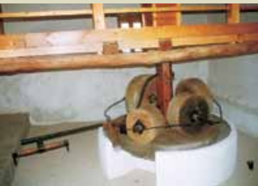
Σάλακος, Ελαιοτριβείο. Ελαιόμυλος με τέσσερις μυλόπετρες, 2008.
