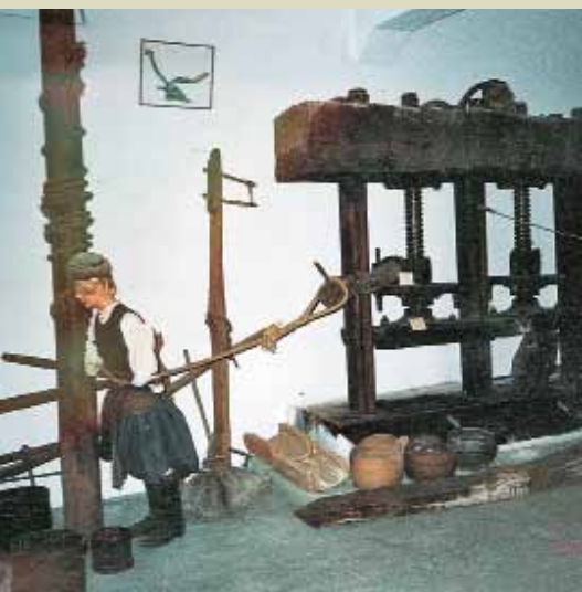
Απόλλωνα, Λαογραφικό Μουσείο-Ελαιοτριβείο. Διπλό μάγγανο με ξύλινες πλάντρες, σιδερένια αδράχτια με ρόδα, μανέλα και αργάτη, 2000.
